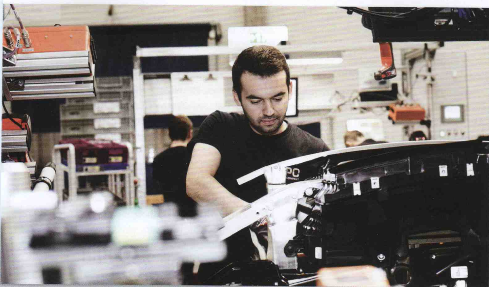
HBPO liefert montierte Frontend-Module für Automobilhersteller im JIS-Verfahren.
